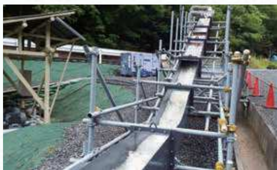
自社研究圃場における流速試験
