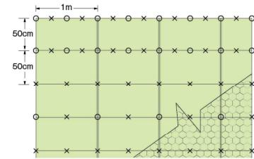
アンカー・止め釘規格、打込み位置については標準として示しておりますので、現地条件に合わせて適宜対応してください。
